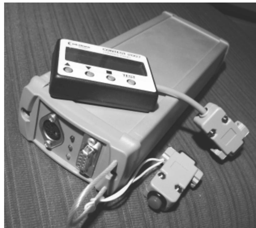
HF/VHF AUTOMATIC ARDF TRANSMITTER
