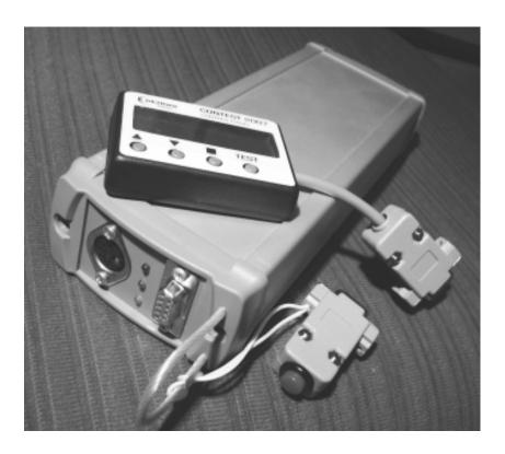
HF/VHF AUTOMATIC ARDF TRANSMITTER
